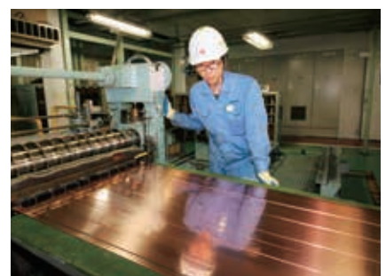
銅板条を製品幅に切断し、巻き取っていきます。その後、梱包されて出荷されます。
