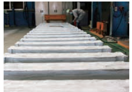
並べられた重さ約1トンの亜鉛のインゴット(鑄塊)。 一つ一つ手作業で仕上げられます。
