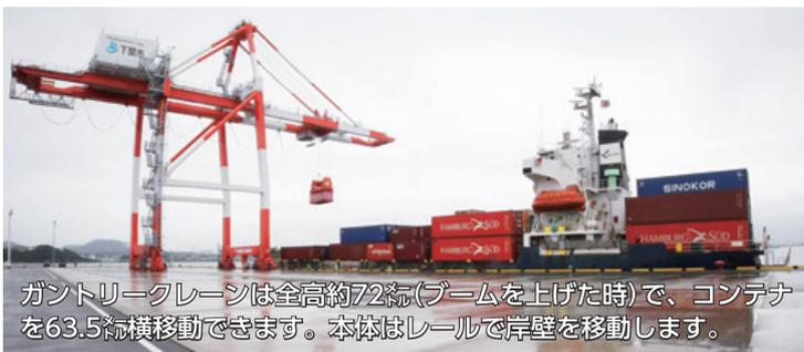
ガントリークレーンは全高約72m(ブームを上げた時)で、コンテナを63.5m横移動できます。本体はレールで岸壁を移動します。
