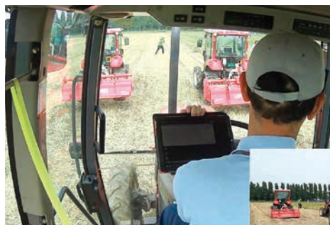
▲オペレータ1人でロボットトラクターを3台動かすことができる協調作業システム。
