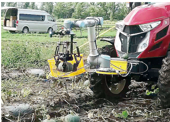
▲ロボットトラクターが、畑の中を自律的に移動しながら、収穫ハンドを使って収穫します。「AIで成熟したカボチャだけを識別し、傷をつけないで収穫できます。今後、キャベツやスイカなどに展開するつもりです」と野口教授。
