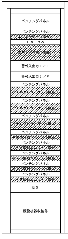
撤去機器図 (赤間町駐車場機器収納架)
