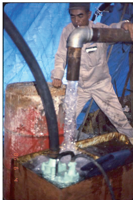
▲湯本温泉市有3号泉の揚水テストの様子
