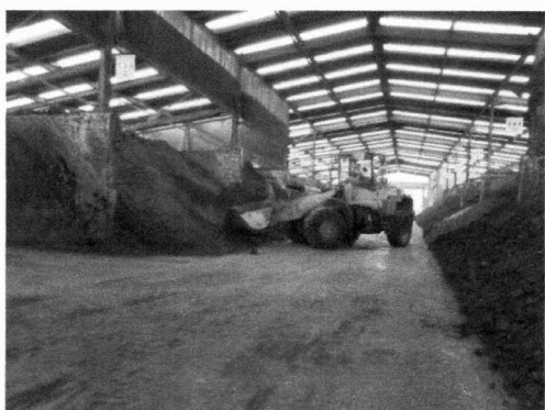
作業状況（重機による混合）
