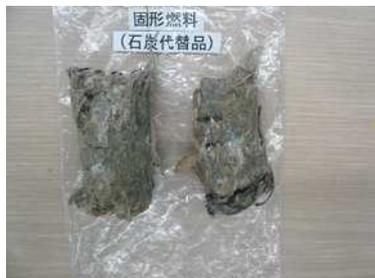
工場で使用する石炭の代替燃料として使用されている。価格は石炭の3分の1から4分の1の値段で、ごみ由来の固形燃料を使うことから、地球に優しく、CO<sub>2</sub>の削減に寄与している。
