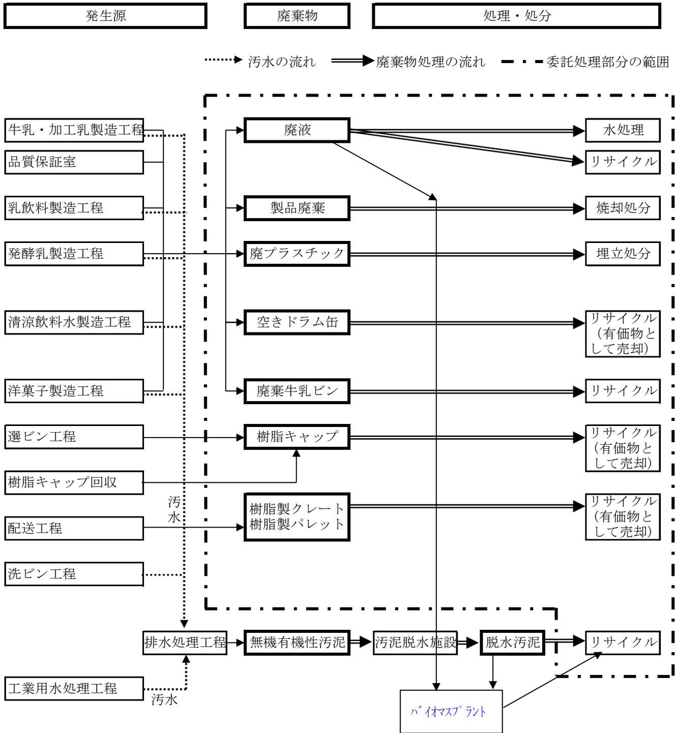
図1 牛乳・加工乳製造フローシート
