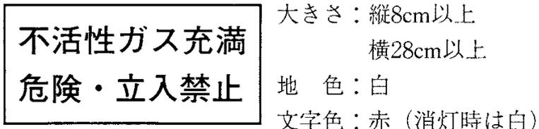
カ 放出表示灯を設ける出入口の見やすい箇所に、保安上の注意事項を表示した標識を次図の例により設置すること。
