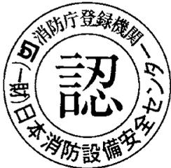
外環と内環の径の比率は、<br>5 : 3とする。<br>2<br>ショウボウチヨウトウロク<br>F E S C <span style="border: 1px solid black; padding: 2px;">ニ ン テ イ</span> |
