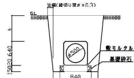
根切り1500H以上 重圧管断面図 S:1/50
