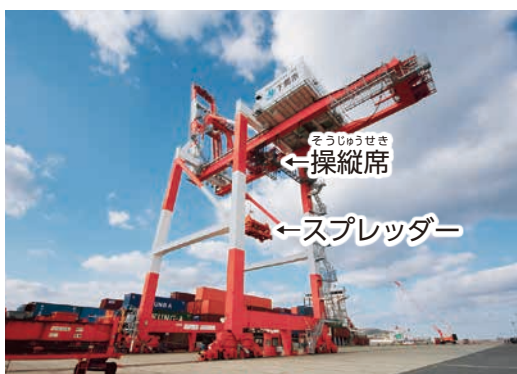
足元はガラス張り。 真上からコンテナをつかむ。
