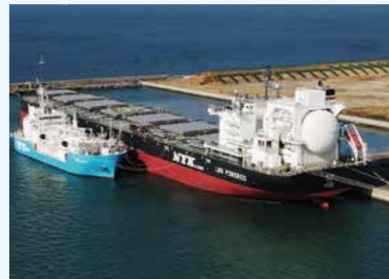
LNG燃料バンカリングの様子
