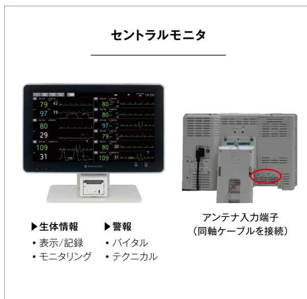
《付図1-3》セントラルモニタの構成
