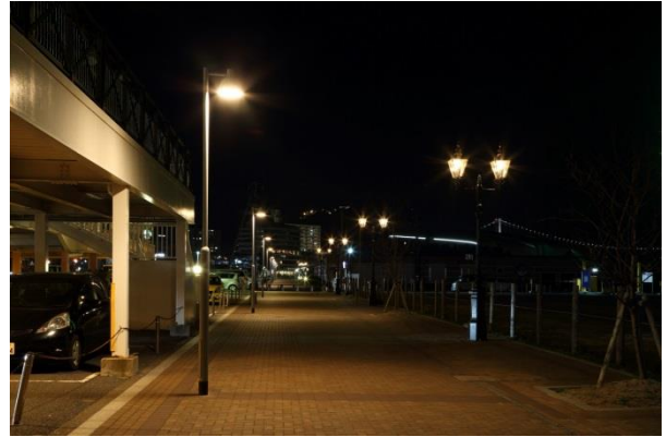
整備後（歩道に沿って暖色系のガス灯を設置）
