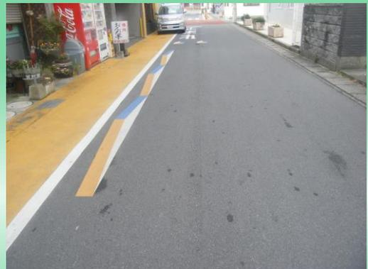
道路上に凹凸があるように着色をすることでドライバーに注意をうながし、車両速度の低減を促す手法。
