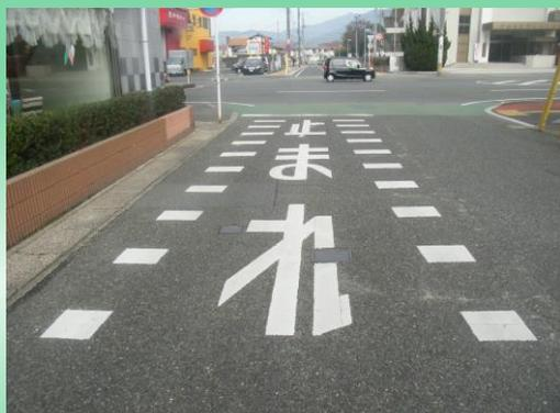
停止線手前の『とまれ』表示にラインを併せて設置することにより、ドライバーに停止線手前での一旦停止を促し、横断する歩行者との出会い頭の衝突を防止する手法。
