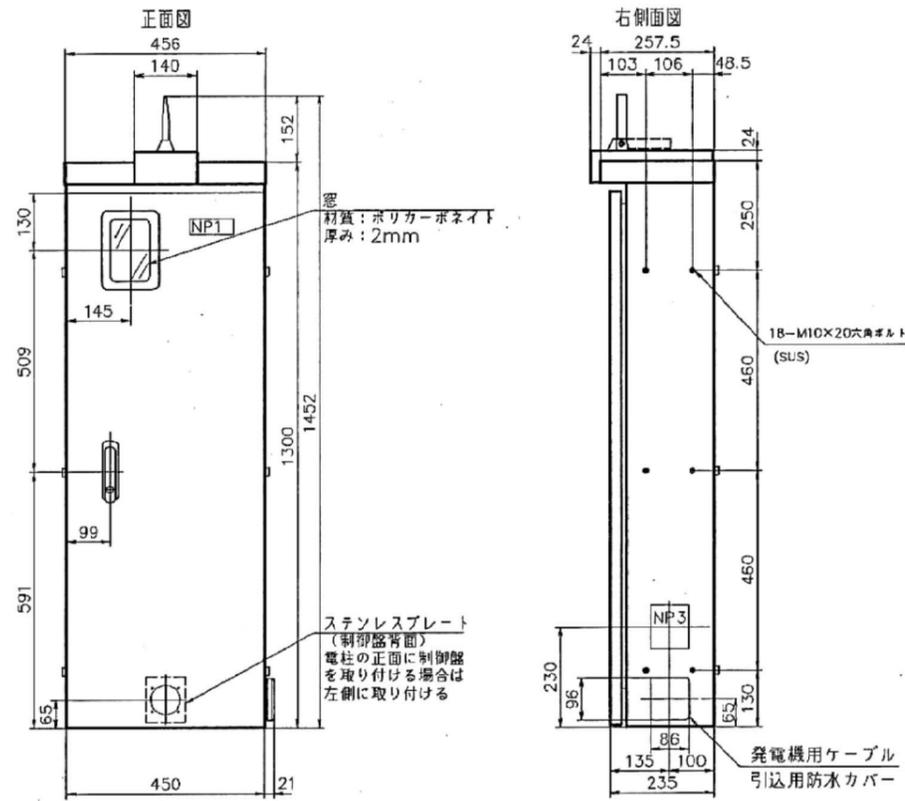
マンホールポンプ制御盤参考図 S=Free
