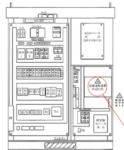
マンホールポンプ制御盤内部配置参考図 S=Free
