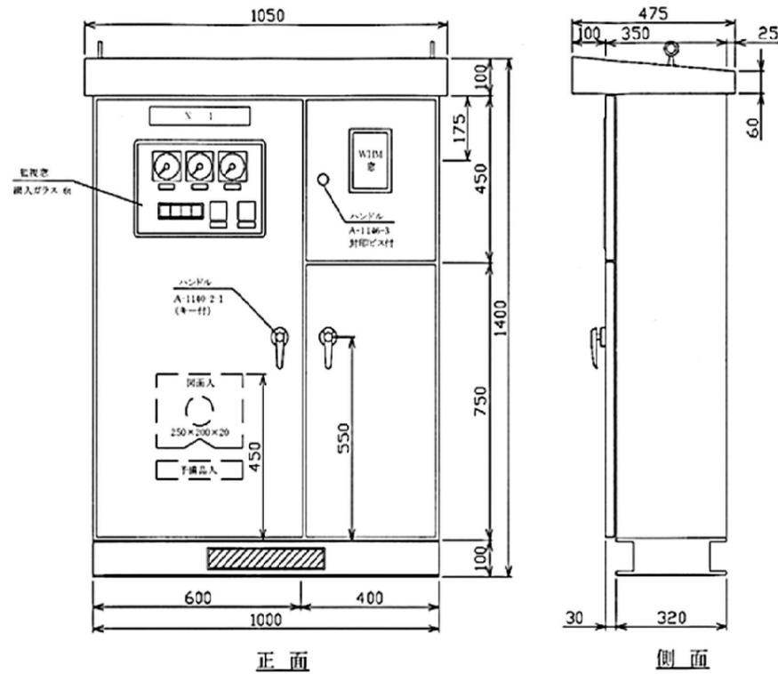
マンホールポンプ制御盤参考図 S=Free
