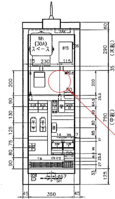
マンホールポンプ制御盤内部配置参考図 S=Free
