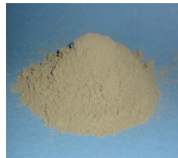
図 3.4.8 下水汚泥の再利用(セメント原料)
